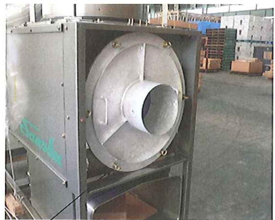
K型の場合はアイナットを外す(6箇所) F、G型の場合ボルトを外す
